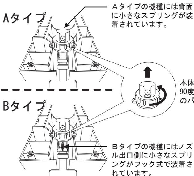
Aタイプの機種には背面に小さなスプリングが装着されています。
