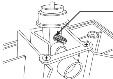
小さな突起にバネがボンド付け状態で固定されています。新しく取り付ける際も必ずボンドで固定をしてください。
