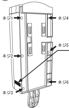
図の指示にある6箇所のネジをドライバーで外します。この時指示以外のネジを外さないように注意してください。
